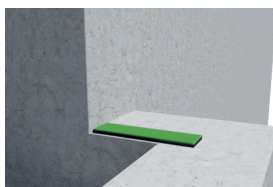
Figure 10 : Positionner la bande perpendiculaire à la largeur de l'appui
